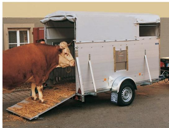
**VR 1801** in Aluminium-Ausführung mit 1250 mm hohen Seitenwänden. **Zubehör:** Regelbarer Lüftungsschieber (450 x 300 mm) in Seitenwand, Dachgestell und Plane 600 mm hoch.
