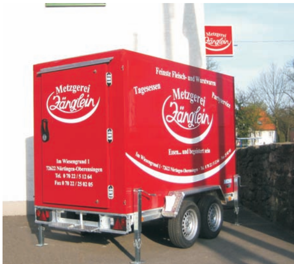
IK 2702, Innenmaße: 2940 x 1440 x 1800 mm hinten mit einer einflügeligen Türe 1100 mm breit. Bequeme Beladung durch Trittstufe hinten. Standfest durch 4 Stück Teleskopstützen (Zubehör) vorne und hinten.
