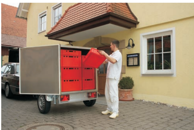
TC 751, Innenmaße: 1390 x 1015 x 1030 mm; mit extra weitöffnender Einflügel-Türe - der perfekte Minikühler für Parties, Catering und Hotelgastronomie als preiswerte Alternative zum Großraumkühler. Serienmäßig komplett mit Kühlgerät (Beschreibung folgende Seite). Er fasst 25 Eurokisten E2.
